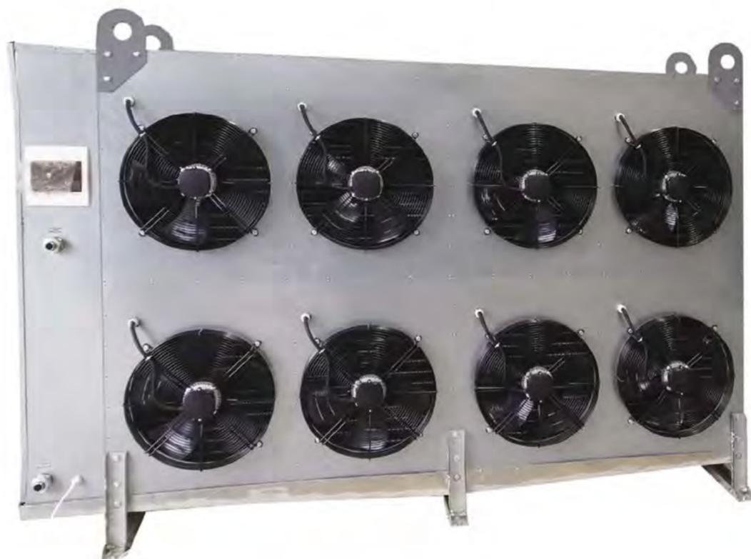
Газификатор состоит из двухконтурного теплообменника и регулирующей арматуры и блока управления. Нагрев на испарение жидкой углекислоты в газификаторе происходит непосредственно в теплообменнике за счет теплоты окружающего воздуха.
