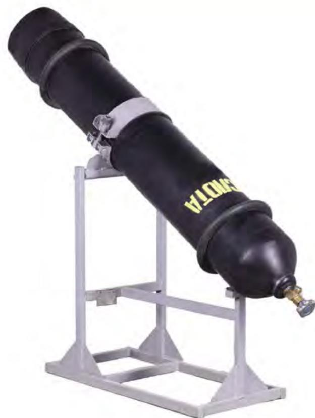
Опрокидыватель баллонов стационарный предназначен для опрокидывания (переворачивания) 40-литровых баллонов с углекислотой в наклонное (рабочее) положение при использовании совместно с зарядными станциями для наполнения углекислотных огнетушителей ОУ-1... ОУ-10 и баллонов малого объема.
