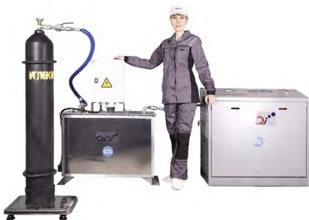
Станция состоит из насосного блока, водяного газификатора, системы управления и электронных весов, которые выполнены в полной заводской готовности и не требуют монтажных работ. Наполнение может осуществляться в режиме с ручным или автоматическим отключением насоса по достижении наполняемым баллоном заданного веса.
