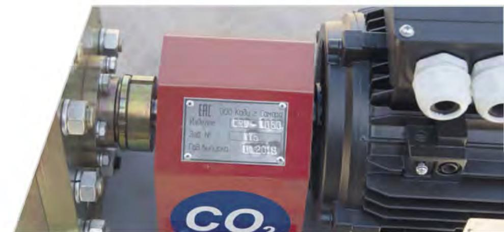
Насос для перелива предназначен для перелива жидкой двуокиси углерода из одной емкости в другую.
