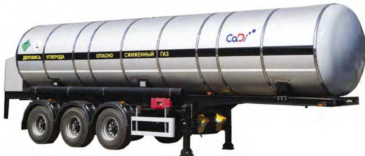
Внутренний сосуд резервуаров изготовлен из низколегированной углеродистой стали. Изоляция резервуаров выполнена из высококачественного двухкомпонентного жесткого пенополиуретана, имеющего отличные теплоизоляционные и гигроскопические свойства, не пропускающего влагу к поверхности сосуда, что защищает резервуар от коррозии и обеспечивает длительное хранение углекислоты со среднесуточным подъемом давления не более 0,08 МПа при среднесуточной температуре окружающей среды +30°C.
