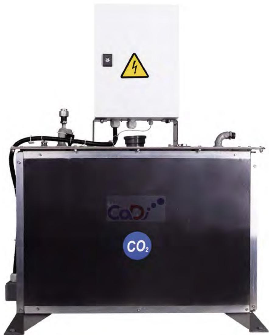
Газификация и подогрев жидкой углекислоты происходит путем теплообмена между нагреваемой водой (или другим жидким теплоносителем) и углекислотой, проходящей по медному теплообменнику.
