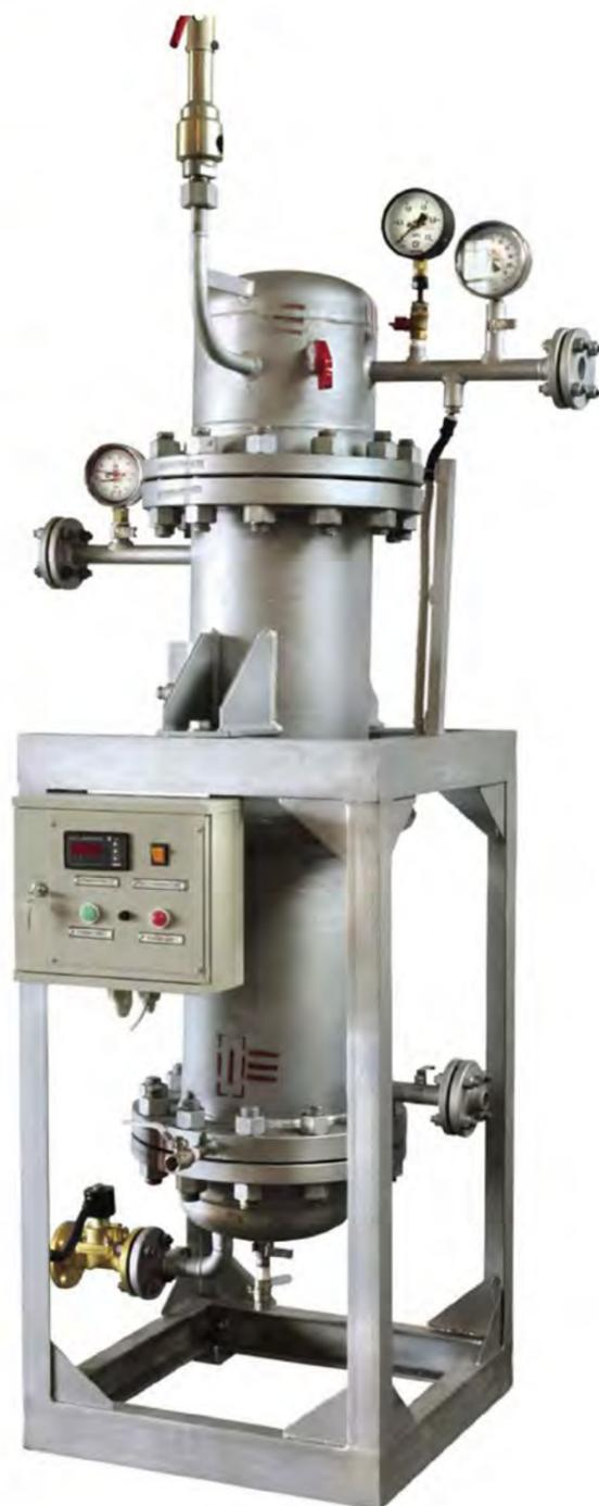
На газификатор дополнительно может быть установлена система защиты технологического оборудования Заказчика от несанкционированного попадания в него жидкой (низкотемпературной) углекислоты. Система состоит из электромагнитного клапана, который управляет подачей жидкой углекислоты в газификатор и датчика температуры на выходе из испарителя. В случае понижения температуры газа до отрицательного значения система автоматики подает команду на закрытие электромагнитного клапана.
