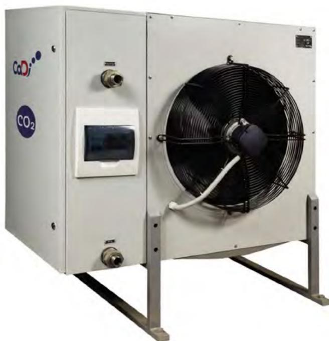
Газификатор состоит из двухконтурного теплообменника и регулирующей арматуры и блока управления. Нагрев на испарение жидкой углекислоты в газификаторе происходит непосредственно в теплообменнике за счет теплоты окружающего воздуха.
