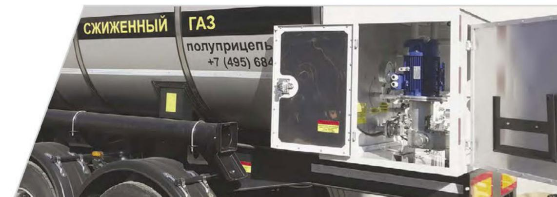
Газификатор предназначен для испарения жидкой двуокиси углерода и подачи углекислого газа на потребление.
