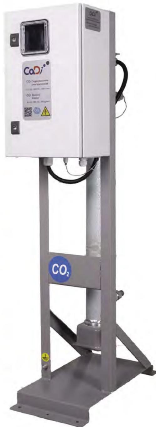
Высокоточное поддержание температуры газа на выходе из подогревателя осуществляется с помощью измерителя-регулятора, подающего сигналы на импульсное включение ТЭНов по пропорционально-дифференциально-интегральной закономерности.
