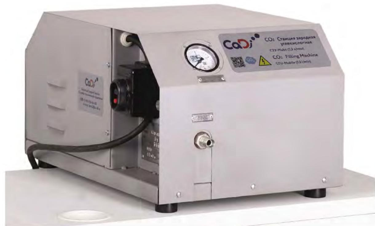
Станция имеет в своем составе манометр, позволяющий контролировать давление наполнения огнетушителя в процессе наполнения. Конструкция станции исключает попадание масла смазки в заряжаемый баллон. Насосный блок и система трубопроводов станции имеет защиту от аварийного превышения рабочего давления станции во время ее работы или стоянки под давлением — сброс углекислоты через разрывную мембрану.
