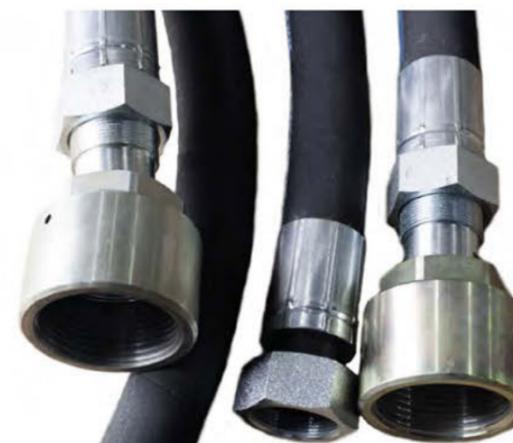
Для подключения к стационарным резервуарам и транспортным цистернам станция дополнительно комплектуется гибкими рукавами. Стандартный комплект рукавов включает в себя: два рукава DN32, PN63, L2000 с гайками на оголовках M45x2 и Tr70x4 и один рукав DN32, PN63, L3000 с гайками на оголовках Tr70x4.
