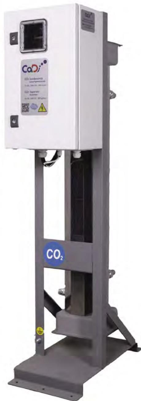
В процессе работы газификатора автоматическое включение и выключение электрических нагревательных элементов происходит в соответствии с сигналами от датчиков температуры и давления, поддерживая их значения на том уровне, который задается уставками температуры и давления на приборах газификатора.
